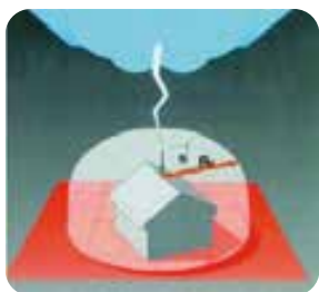
Protection radii according to standards UNE 21186 and NF C 17-102
